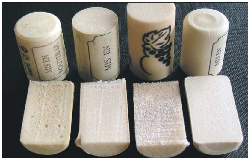
De gauche à droite, bouchon moulé par injection, co extrudé, extrudé et injecté.
